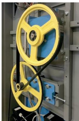
Les séchoirs IMESA proposent une construction mécanique d'une qualité incomparable, autour d'un châssis mécano soudé au laser, poulies d'entraînement en fonte avec 4 roulements SKF, courroies plates pour une plus grande longévité et un faible bruit de fonctionnement. L'accessibilité technique est très aisée.
