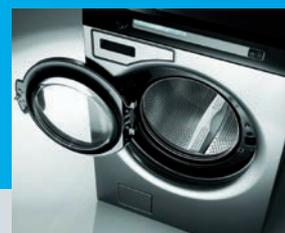
Le hublot plat, fixé sur la cuve, libère une zone de chargement tout inox. Le joint de hublot, situé côté «ouvrant», n'est donc pas fragilisé par les opérations de remplissage.
