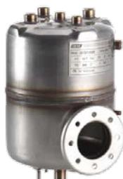
Selon les modèles, la table est équipée d'une chaudière inox AISI316 à remplissage automatique (5 litres, autonomie illimitée) avec résistance incoloy sur bride, et fer ambidextre avec poignée ergonomique, ou livrée sans chaudière ni fer.
