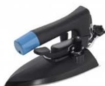
Le fer «tout vapeur» est très apprécié des pressings, pour sa légèreté, la qualité de finition et l'absence de lustrage des fibres. Sans aucun composant électrique, il utilise la vapeur pour chauffer la semelle. Equipé de deux flexibles téflon de 250cm : entrée vapeur et retour des condensats vers la réserve d'eau de la chaudière.
